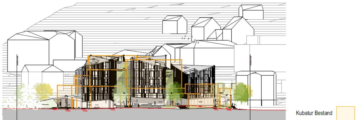
Abbildung 17: Ansicht Nord mit Überlagerung der bestehenden Gebäudekubatur (Quelle: Hohensinn Architektur)
