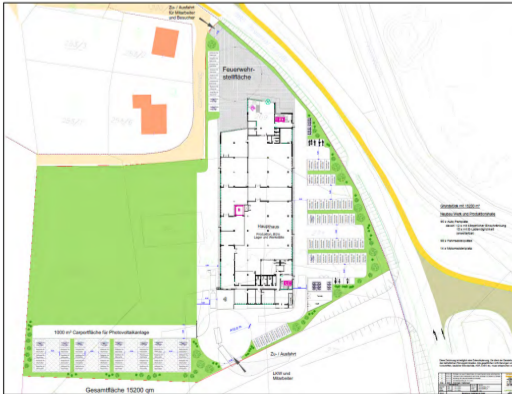
Abbildung 7: Bebauungskonzept Baustufe 1 (Quelle: CAD.Office Leipzig / Leitner GmbH)
