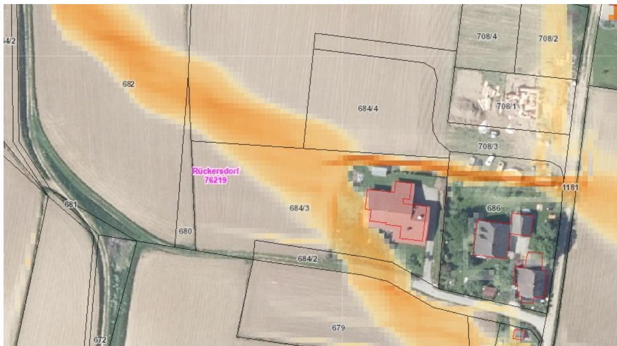
Abbildung 1: Hauptabflusskorridor im nördlichen Bereich des Grundstücks 684/3 KG Rückersdorf
