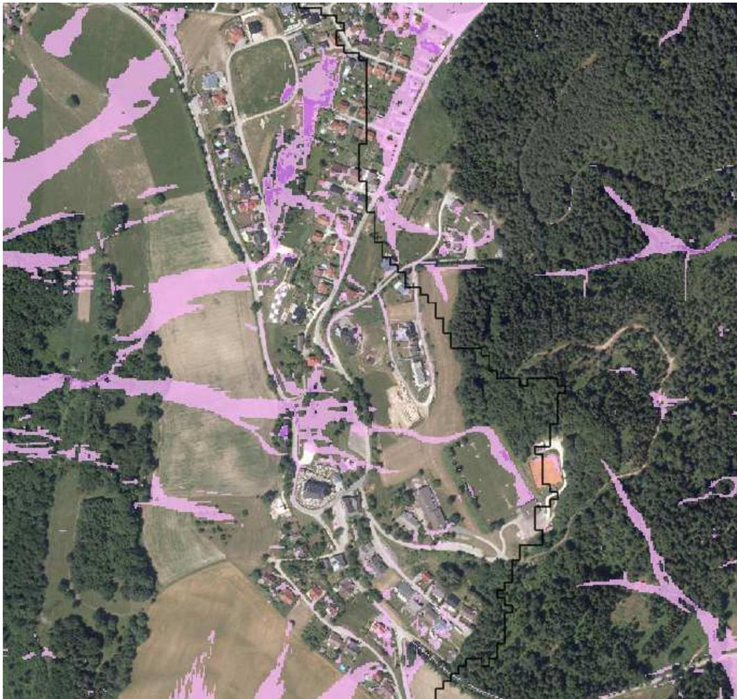
Abbildung 4: Hinweiskarte Oberflächenabfluss (Quelle KAGIS)
