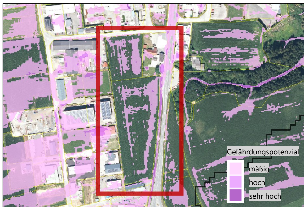
Hinweiskarte Oberflächenabfluss (Quelle: KAGIS)
