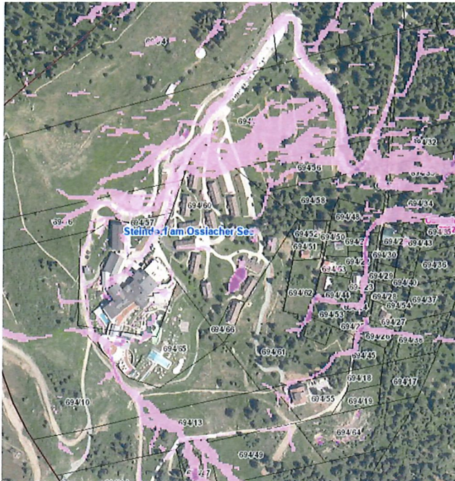
Abbildung 5: Oberflächenwasserabfluss (Quelle: Kagis)
